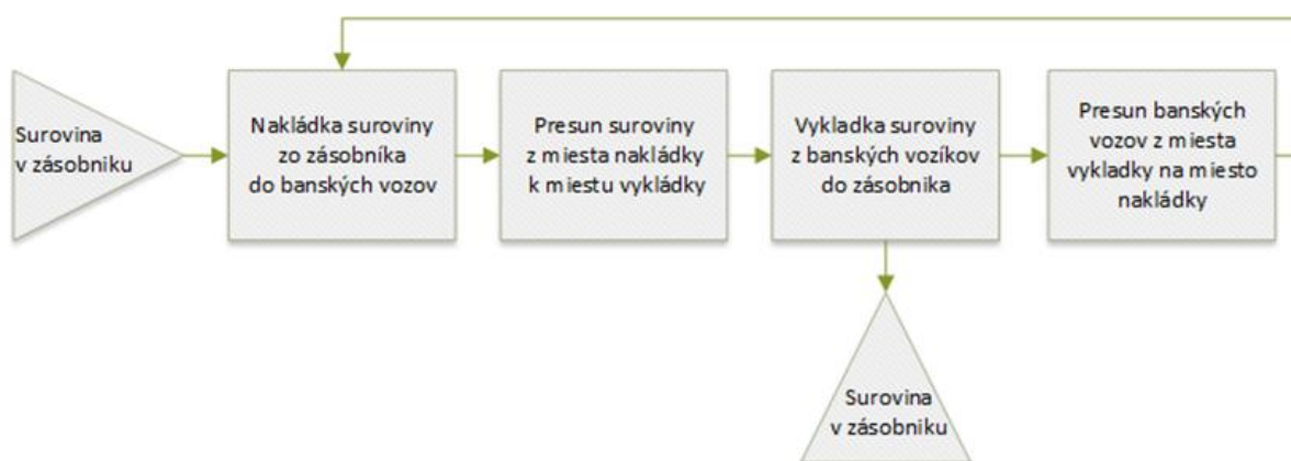
Obr. 1 Schéma dopravného cyklu pri vykladaní nerastnej suroviny v podzemí Zdroj: autor
