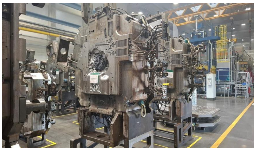
Obr. 1 Formy do odlievacej pece Zdroj: autor
