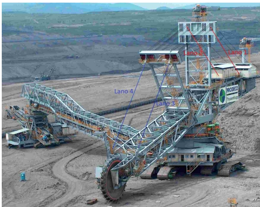
Obr. 1 Rypadlo SchRs 1320 a schéma měřených závěsných lan Zdroj: autor
