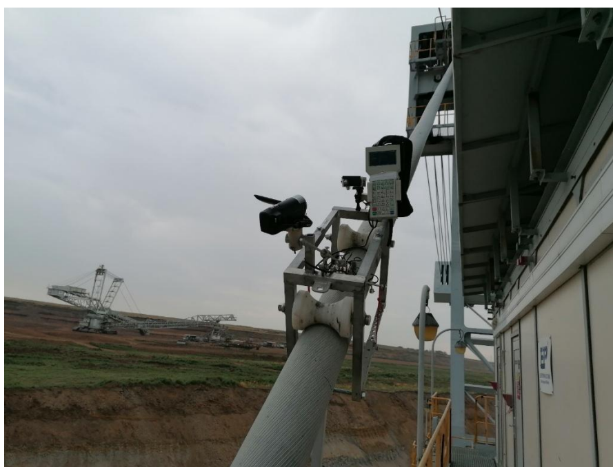
Obr. 2 Pojízdný přípravek pro použití vícekanálové měřicí aparatury Zdroj: autor
