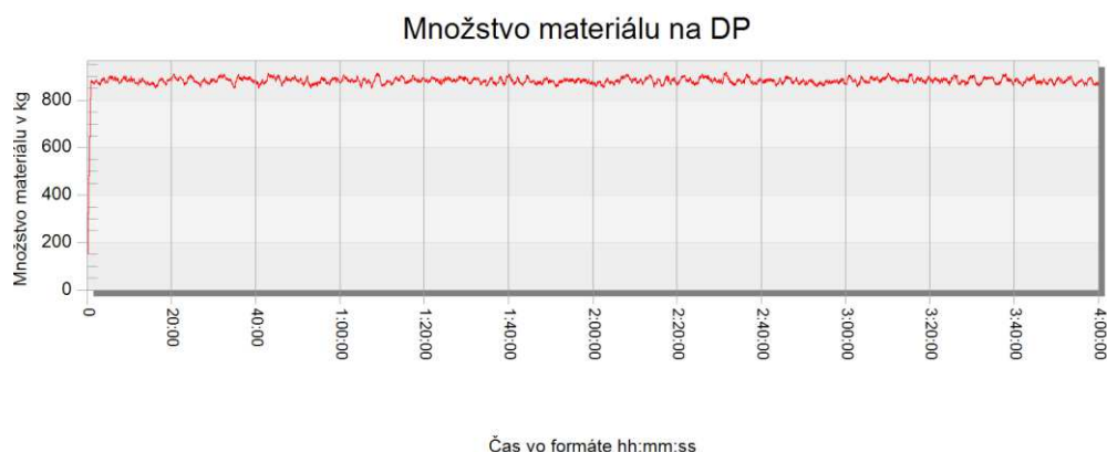
Obr. 3 Závislosť množstva materiálu na čase – Experiment 1 Zdroj: autor
