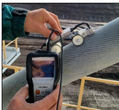
Obr. 5 Měřicí souprava vířivých proudů Zdroj: autor
