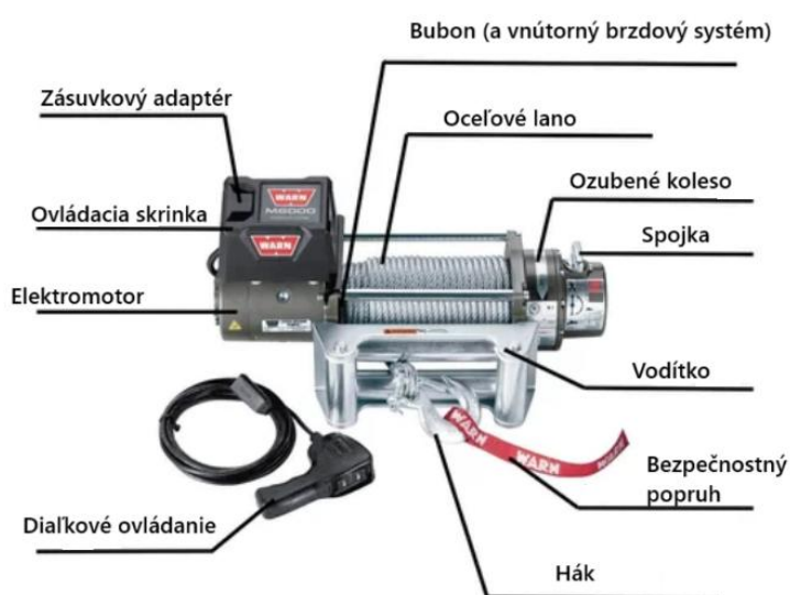
Obr. 3 Komponenty autonavijaku Zdroj: autor
